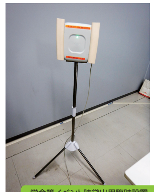
学会等イベント時貸出用臨時設置アクセスポイント / Temporary AP available for rent during events
