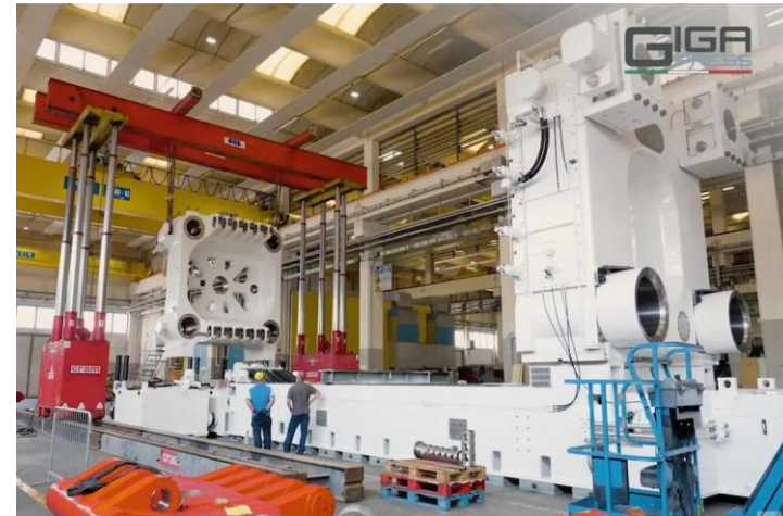
テスラのギガキャスティング装置 (アルミニウムのダイキャスト装置)
