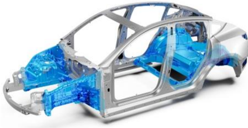
テスラのギガキャスティング構造 (アルミニウム)
